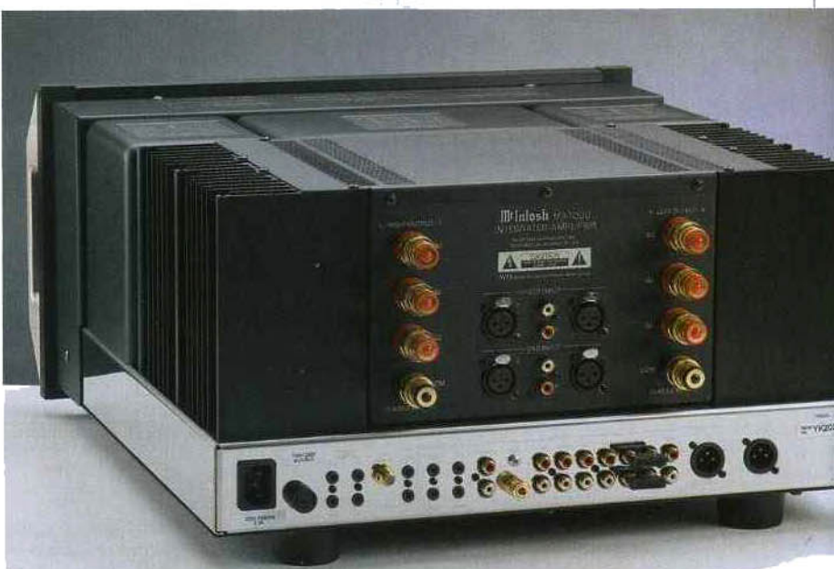
La ricca dotazione di prese ospitate sul pannello posteriore prevede ben sette ingressi, due dei quali anche in versione bilanciata, compreso quello dedicato al giradischi: anche le uscite sono presenti nelle due versioni single-ended e bilanciata e c'è anche la coppia Pre Out/Power In.
