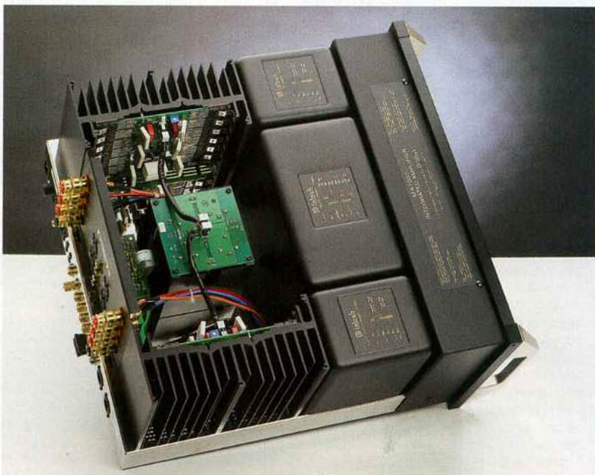
La realizzazione dell'MA7000 segue in tutto e per tutto i canoni caratteristici dei prodotti del marchio: costruzione meccanica molto robusta ed elegante, componentistica di qualità, stadio di alimentazione sovradimensionato e trasformatori d'uscita.
